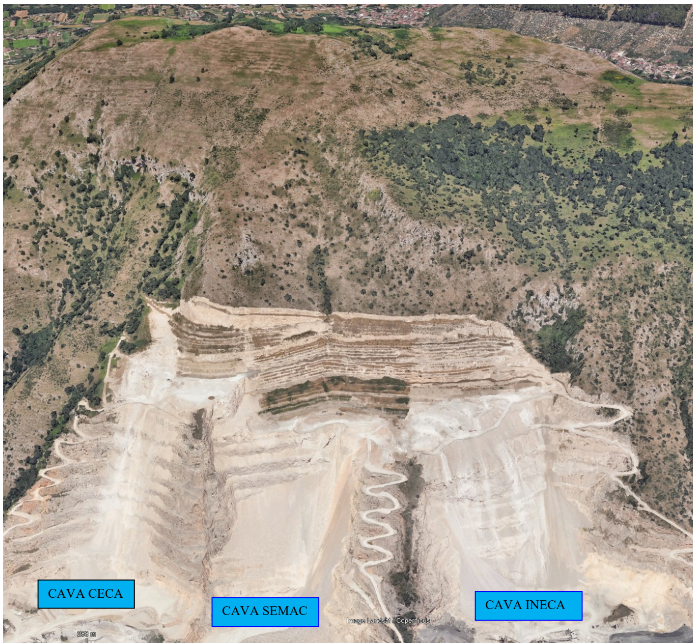
Foto n. 3 - Veduta aerea dell'area in studio: in primo piano si vedono, chiaramente, la viabilità di arroccamento ed i gradoni di cava, oggetto dell'attività estrattiva. Nella stessa è evidente la modesta e trascurabile presenza di terreni detritici sui versanti a monte dell'area di coltivazione.
